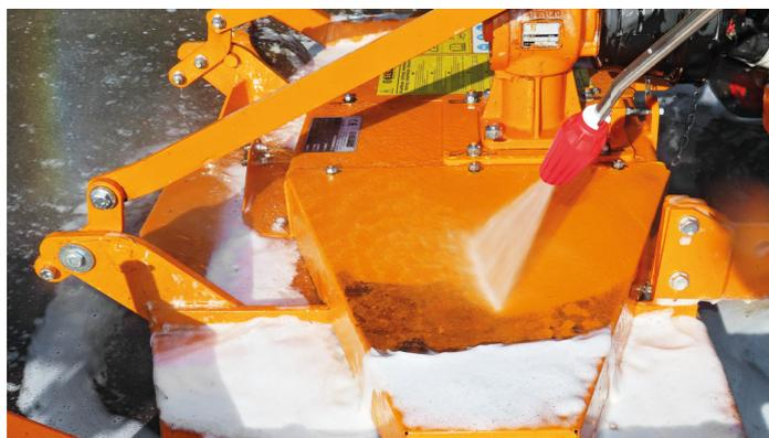
Rotierende Düse mit Edelstahlstrahlrohr (bei KD523 Premium
