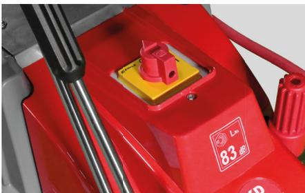
Industrie Betriebswahlschalter, drehbar und robust. Wasserdichter Elektro-Schaltkasten für die elektronischen Steuerungskomponenten mit Sicherheits-Spannung 24V für Schalt- und Befehlsgeräte, separater thermischer Überlastschutz, 4-poliger Schaltschutz für allpolige Abschaltung, Total Start-Stopp System (TSS-System) mit Nachlaufverzögerung 20 Sekunden, Geräte-Totalabschaltung mit Leckage-Erkennung nach 20 Minuten nach Betriebsende mit Leckage-Erkennung.
